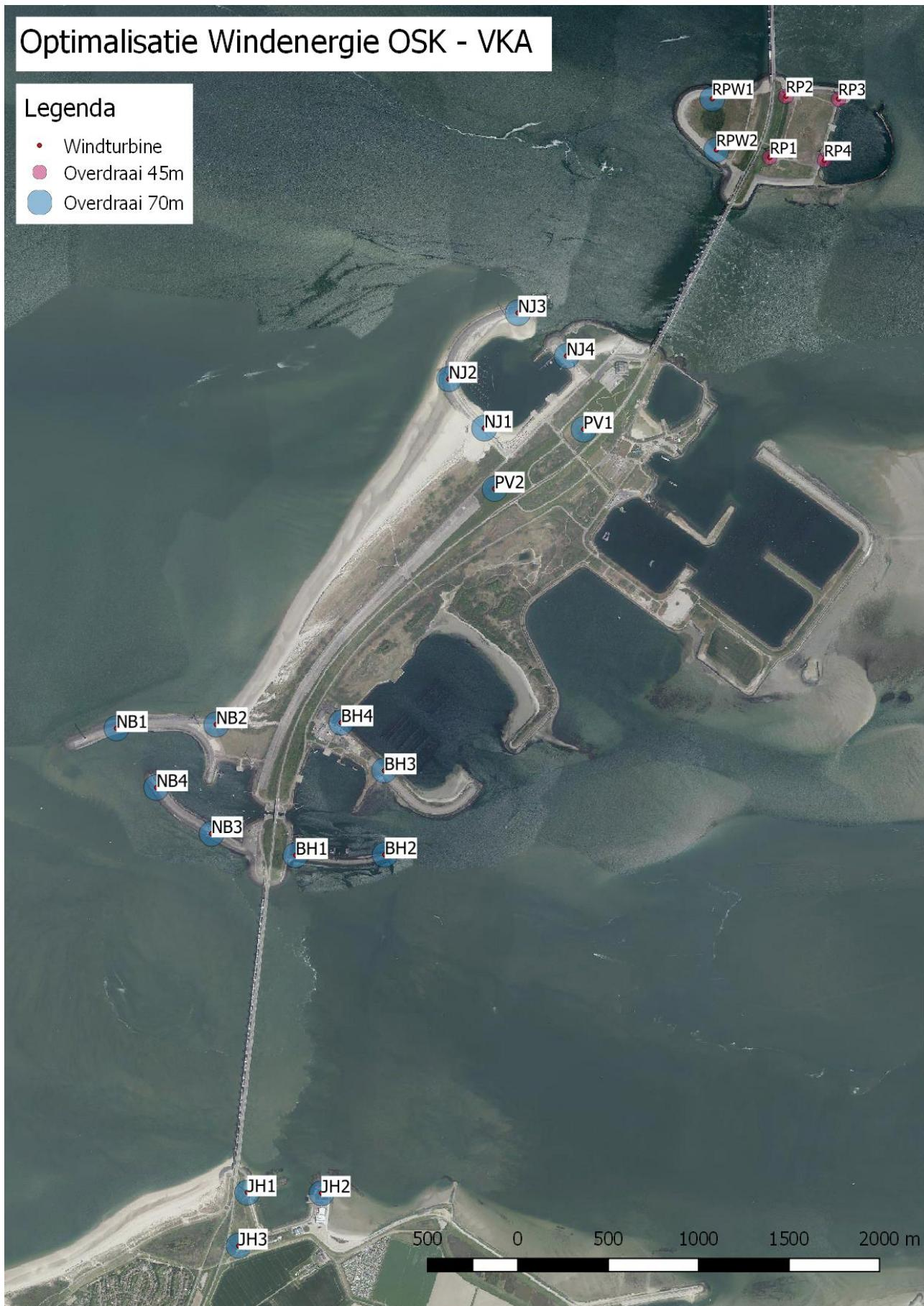
Figuur 2.1 Turbineopstelling VKA inclusief optimalisatie Windpark Roggeplaat West
